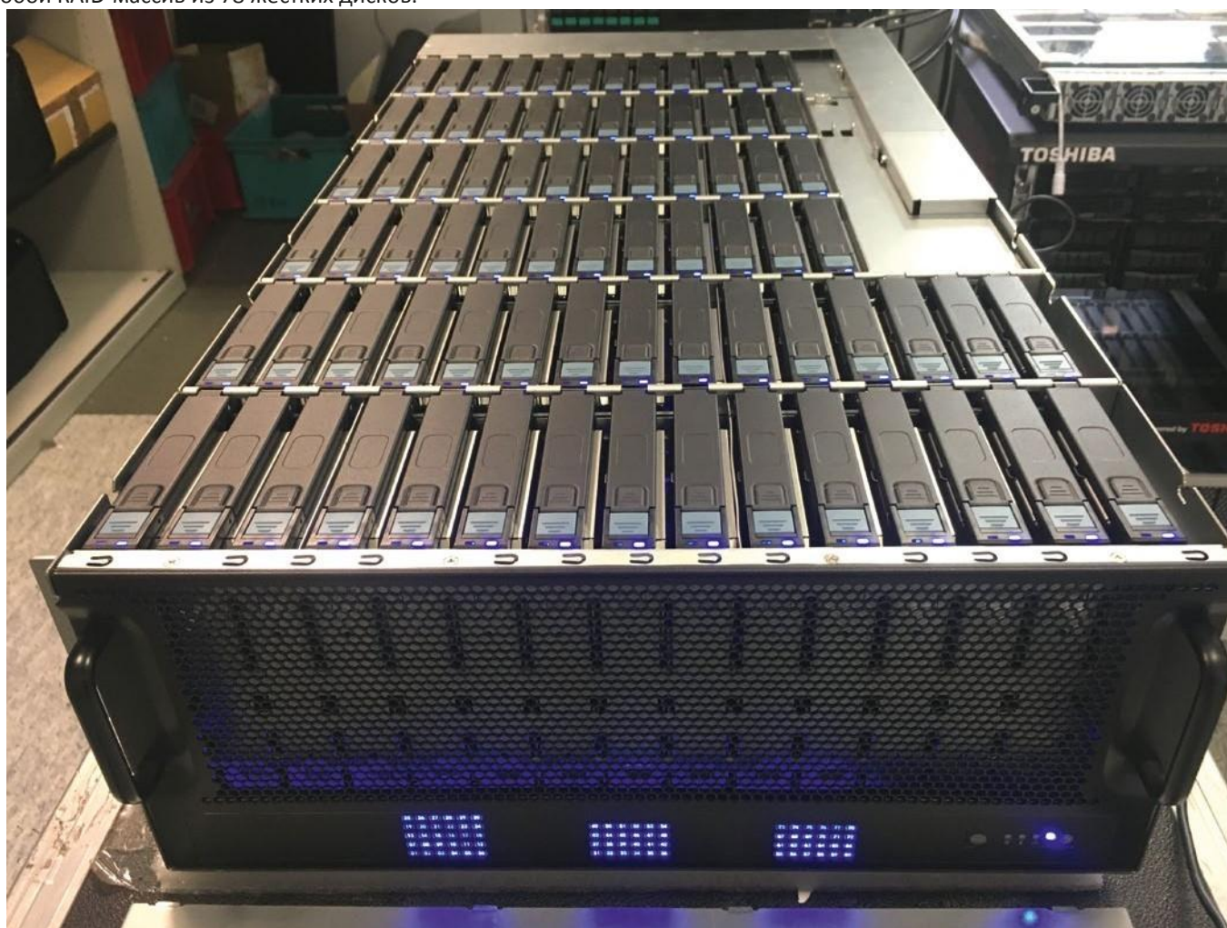
Рис. 3. J4078-01 с 78 жесткими дисками Toshiba
